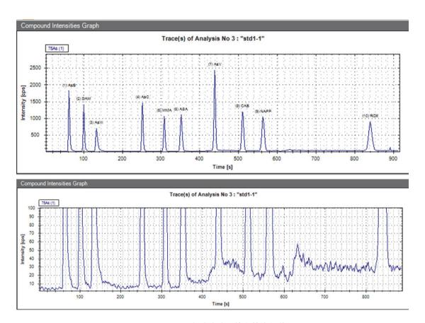
图3. 1.0 µ g/L标准溶液和放大基线色谱图
